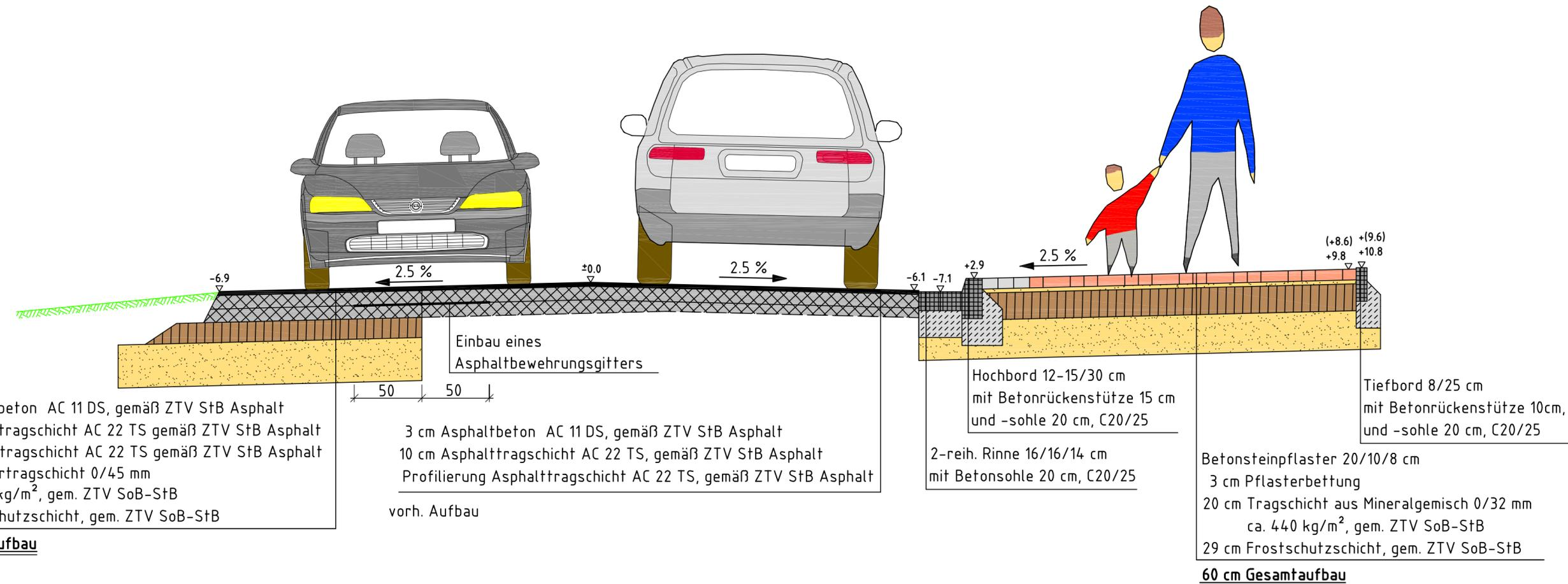
3 cm Asphaltbeton AC 11 DS, gemäß ZTV StB Asphalt
