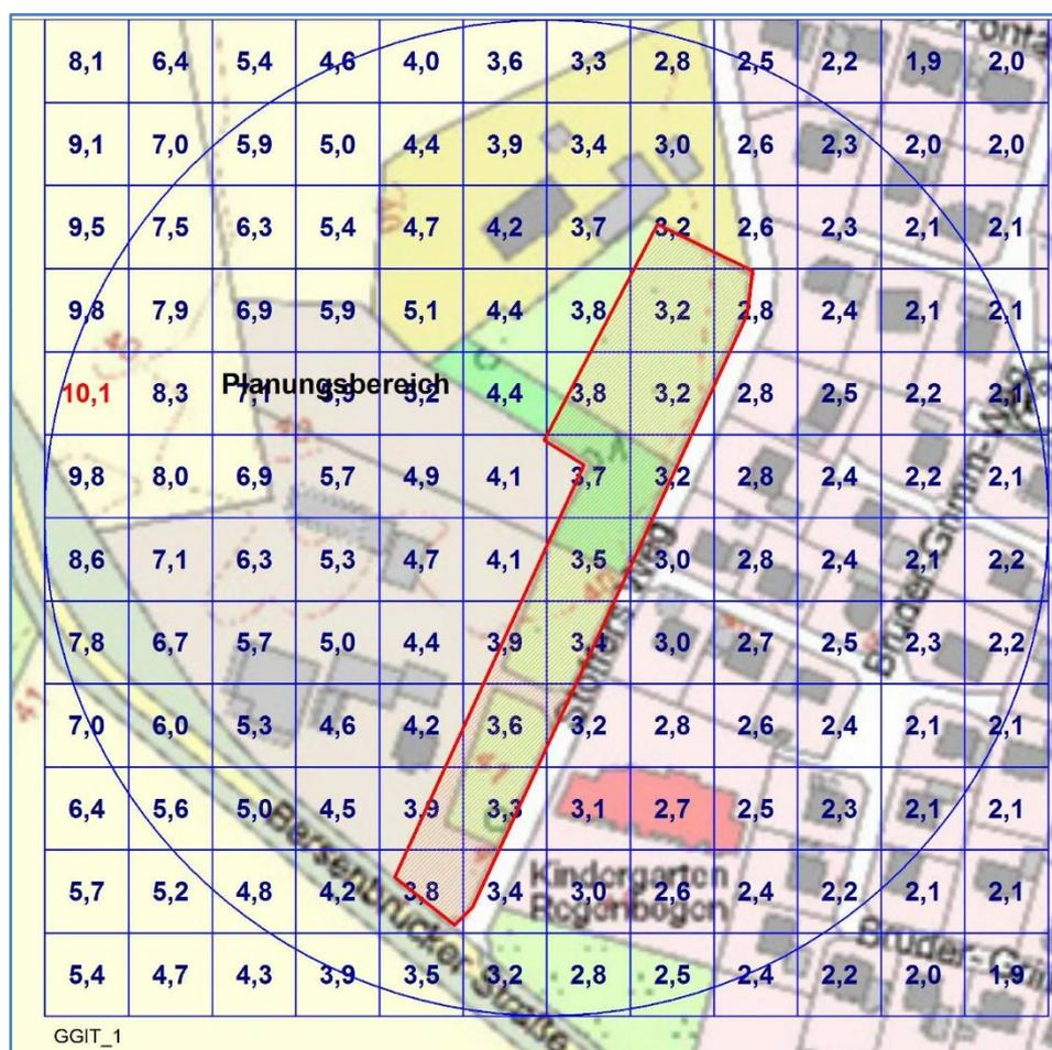
**Abbildung 2:** Darstellung der von den vorhandenen Tierhaltungen induzierten Geruchsstundenhäufigkeiten als Flächenwerte für ein Raster 25 m x 25 m
